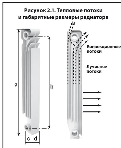
**Рисунок 2.1. Тепловые потоки и габаритные размеры радиатора**
